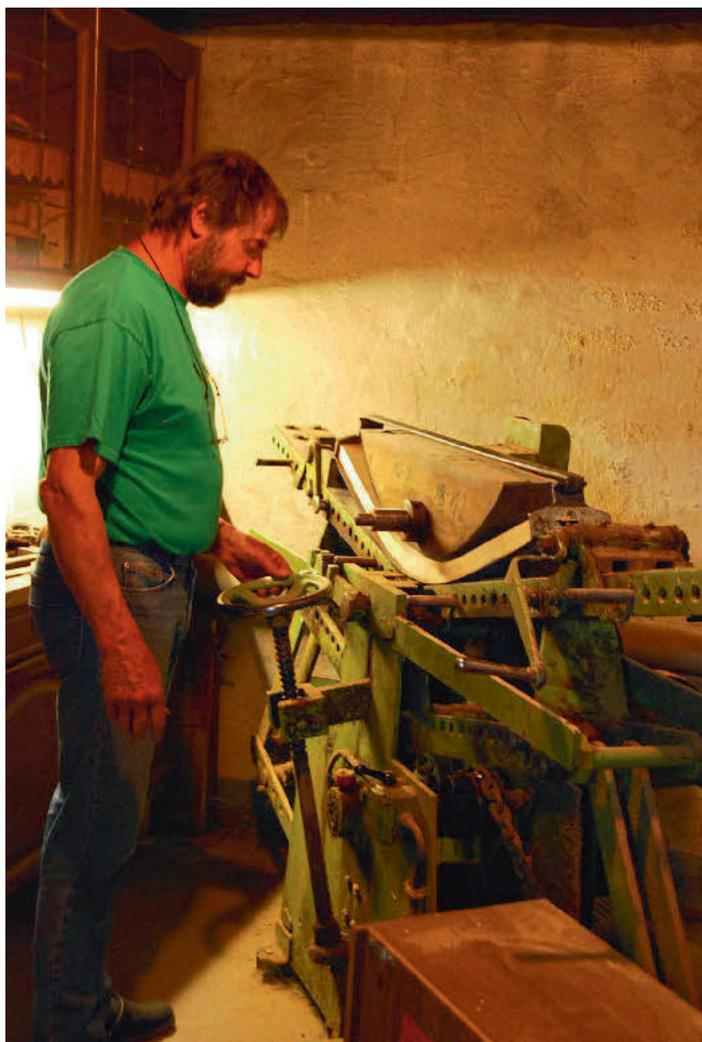
*/ Holz in Form gebracht: Die zuvor gedämpften Rohlinge aus etwa 30 mm starker Buche für die Kufen werden auf einer schweren Biegemaschine gebogen.*
